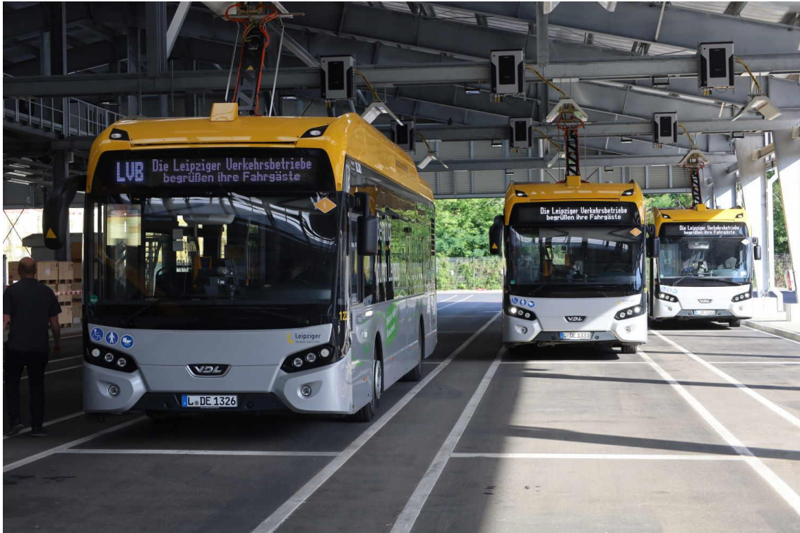
Abbildung 65: Pantographenladung im Depot der Leipziger Verkehrsbetriebe (LVB) [26]
