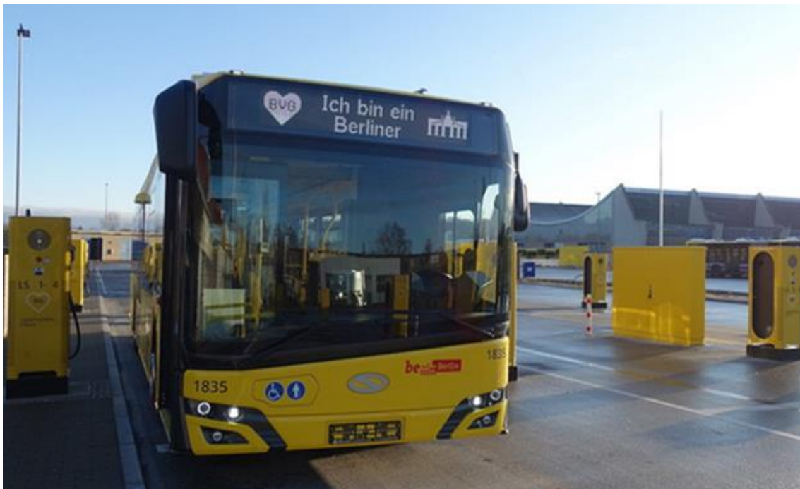
Abbildung 62: Steckerladung im Depot der Berliner Verkehrsbetriebe (BVG) [23]
