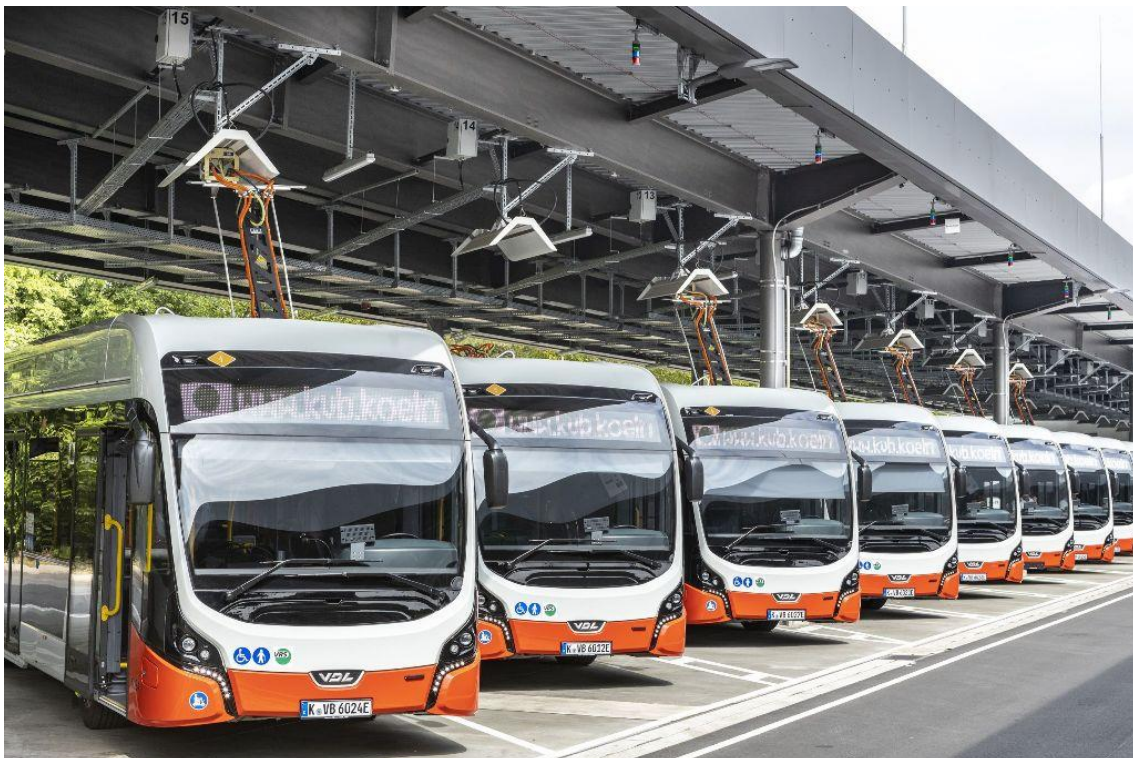
Abbildung 66: Pantographenladung im Depot der Kölner Verkehrs-Betriebe (KVB) [27]
