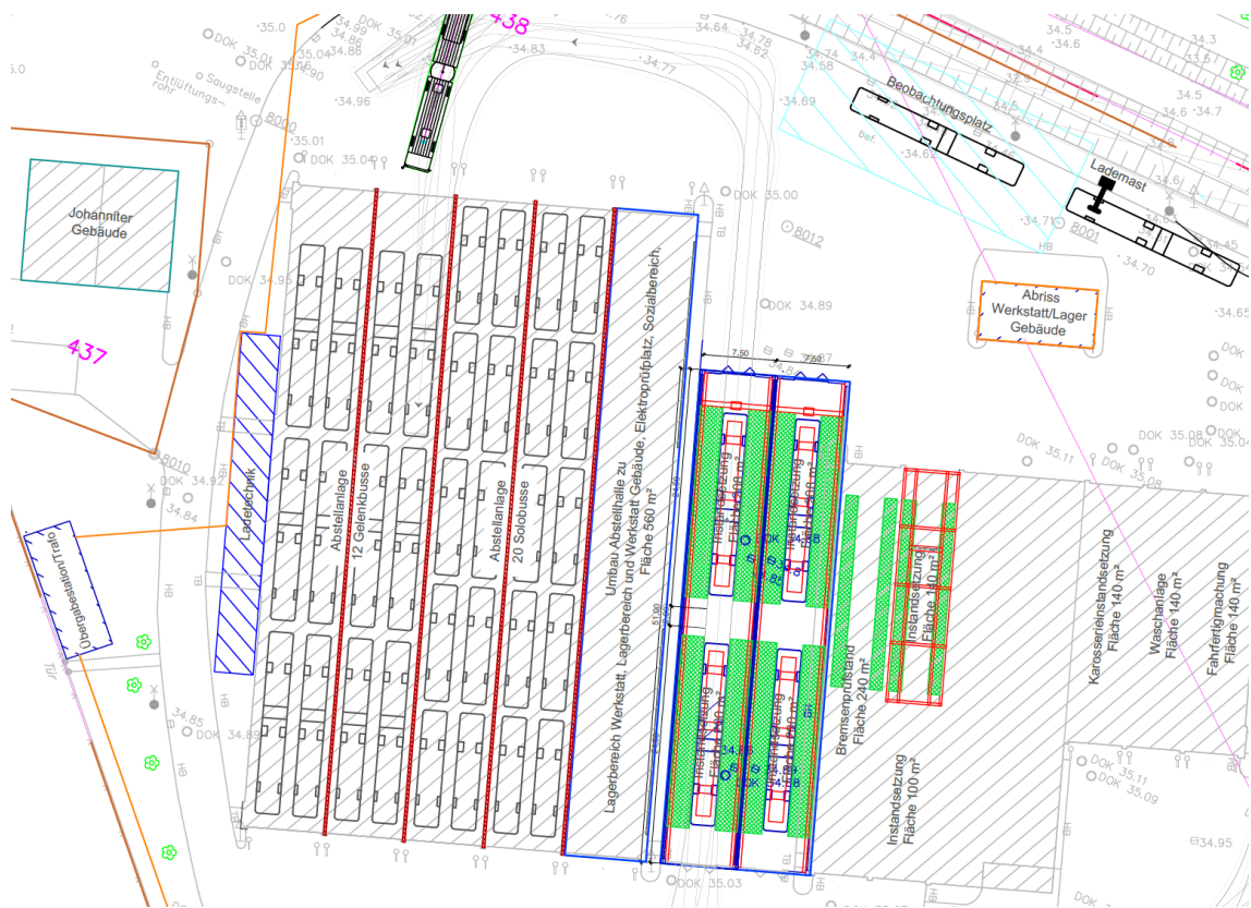
Abbildung 17: Umbauplanungen der Bestandshallen (BA 0, 1, 2)
