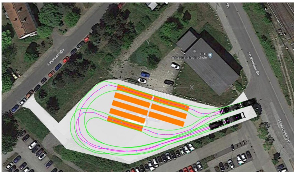
Abbildung 46: Stralsunder Straße Variante 3: 8 Ladepunkte (GL), keine Ausfahrt über Lindenstraße möglich
