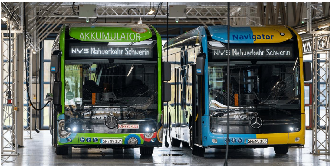
Abbildung 64 Steckerladung im Depot des Nahverkehr Schwerin (NVSQ) [25]
